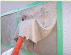
手工具 (刃付スクレーパー、皮スキなど) で、塗膜をはく離します。異なる塗付量で試験をおこなった場合、塗膜はく離結果のほか、塗付量ごとの作業状況を確認します。
