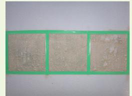
塗付後、18時間以上経過後、塗膜が軟化膨潤した状態であり、はく離作業が可能であることを確認します。
