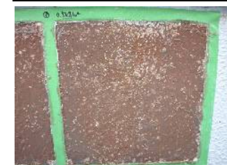
バイオハクリRE 塗付完了状態 (2回目) 塗付量: 0.5kg/m 2 (≒ 45g/0.09m 2 )
