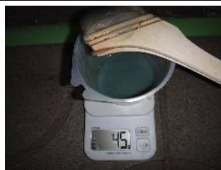
塗付量確認方法: 重量測定管理法 試験区画面積: 0.09\text{m}^2 試験区画への塗付量: 0.5\text{ kg}/\text{m}^2 ( \approx 45\text{g}/0.09\text{m}^2 )
