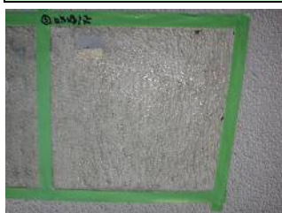
バイオハクリRE 塗付量: 0.5\text{kg}/\text{m}^2 塗付後 24時間経過状態 (1回目)
