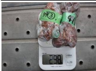
はく離回収した塗膜重量測定状態 298g/0.09m 2 ≒ 3,311g/m 2 (回収塗膜および養生マスキング含む)
