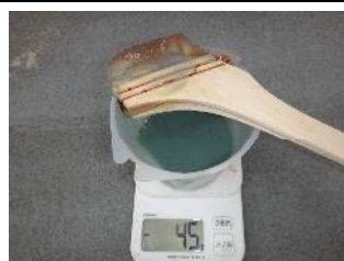
塗付量確認方法: 重量測定管理法 試験区画面積: 0.09m 2 試験区画への塗付量: 0.5 kg/m 2 (≒ 45g/0.09m 2 )
