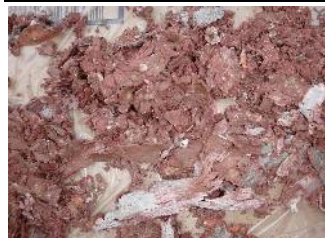
よく離除去塗膜の回収状態 ≒ 「湿潤シート状態」。
