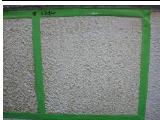
バイオハクリRE 塗付量: 0.5kg/m 2 塗付後 24時間経過状態 (1回目)
