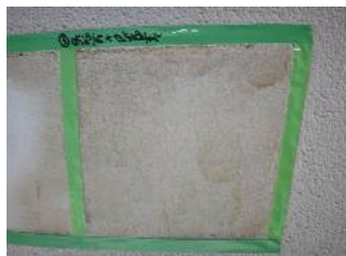
バイオハクリRE 塗付量: 0.5kg/m 2 塗付後 24時間経過状態 (2回目)
